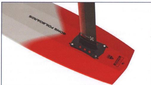
Retournez votre foil équipé de sa platine et posez le sur votre planche au dessus des box US. Utilisez les 4 vis M6 x 30mm pour fixer le foil à votre planche en les vissant fermement dans les carrés en laiton.
