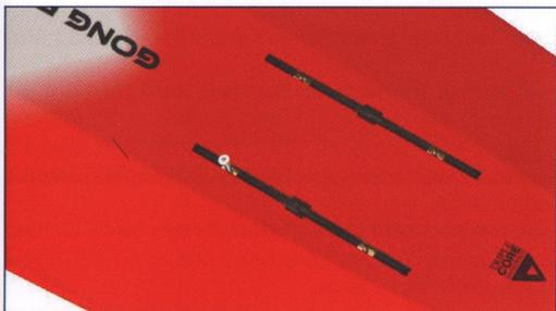
Retournez votre planche sur une surface lisse et protégez le nez et le tail. Insérez deux carrés en laiton dans chaque box US. Faites les coulisser pour les placer en face des inserts de vis de la platine.
